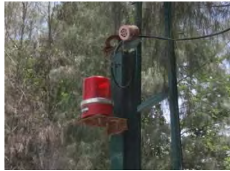
รูปที่ 2-10: หวอสัญญาณเตือนการระเบิด
